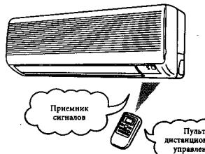
При нажатии любых кнопок на пульте дистанционного управления - при том условии, что пульт дистанционного управления направлен на кондиционер воздуха - передается сигнал. При правильном приеме сигнала прибор издает тональный гудок.
